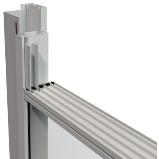
Access. Tverrsnitt av hjørnestolpe.
